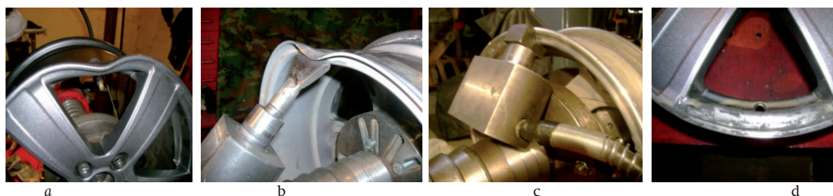
Рис. 1. Виды дефектов и их исправление: a – деформация наружу части реборды и прогиб полки диска; b – исправление деформированной наружу части внутреннего борта диска (реборды); c – исправление деформации посадочной поверхности диска вовнутрь воздействием инструмента на «ребро» боковой закраины; d – вид фрагмента диска после исправления дефектов
